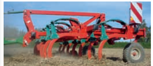
Front kit til CLC Evo 3 og 3,5 m stubharver. Med front kit kan harven monteres både for og bag på traktoren.
