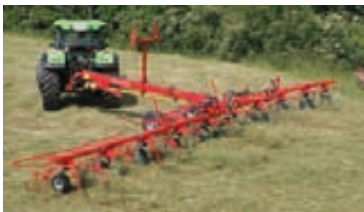
Kverneland ProLine 85140C bugseret med 13,3 m arbejdsbredde - vanderen til det helt store behov.
